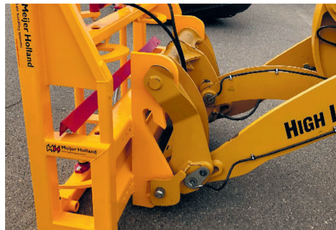
De balenklems is leverbaar met demontabele aanbouwhaken voor ieder type voorlader, shovel, verreiker of kraan.
