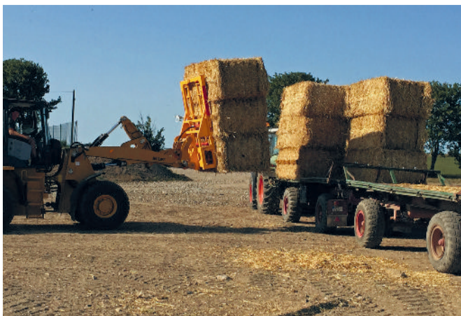
De Fred 3-4HD is geschikt voor drie balen met een hoogte van 90 centimeter of vier balen met een hoogte van 70 centimeter.
