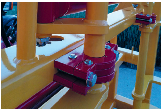
De deelbare lagerblokken bestaan uit zes plaatjes ijzer. Drie plaatjes aan de achterkant en drie aan de voorkant.
