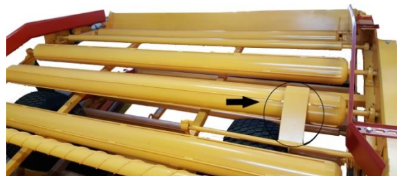
foto D — indrukken klep Limo Hydra 15M
