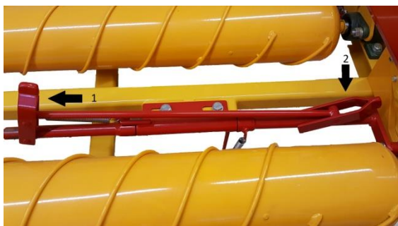
foto A — rode pal bedient automaat
