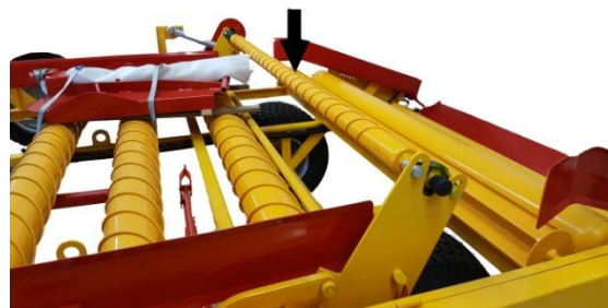
foto B — ontgrendeling kantelrol
