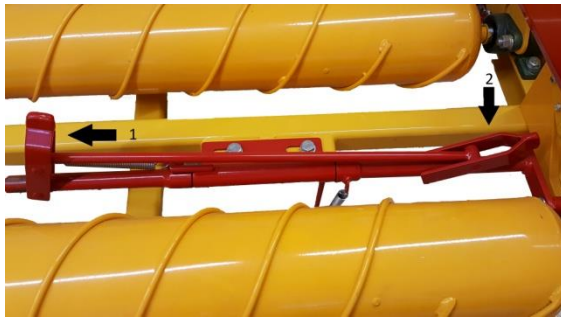
Foto A — Rote Riegel aktiviert die Automatik
